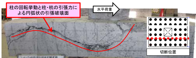
図-17 フーチングの円弧状の引張破壊面
