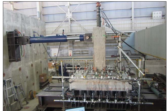
図-3 片側繰返し水平荷重実験状況
