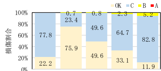
図-2 基層の経過年数に対する損傷ランクの推移 (分析2：密粒度As, 最大わだち掘れ量)
