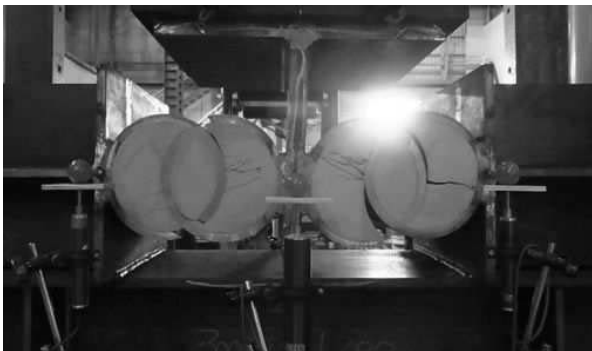
(a) 破壊性状 (S-1 試験体：最大変位時)
