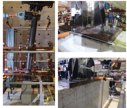
図-11 照明柱最大荷重時の全景:左, 基部 (引張側):右上, 基部 (圧縮側):右下
