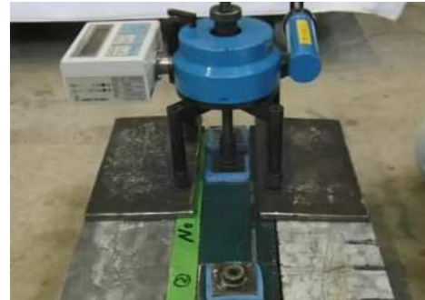
写真-6 付着強度試験
