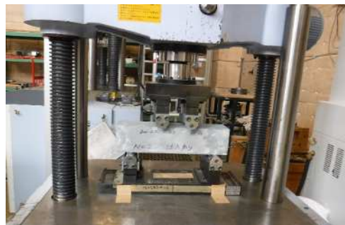
写真-2 3等分点荷重によるひび割れ導入状況
