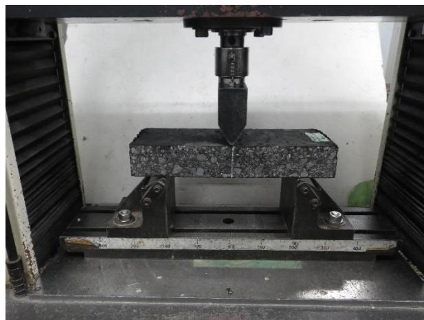
図-3 曲げ試験状況
