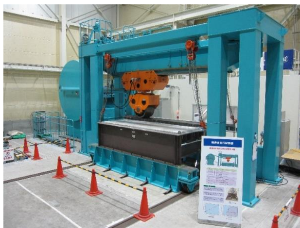
写真-1 輪荷重走行試験(鋼床版)
