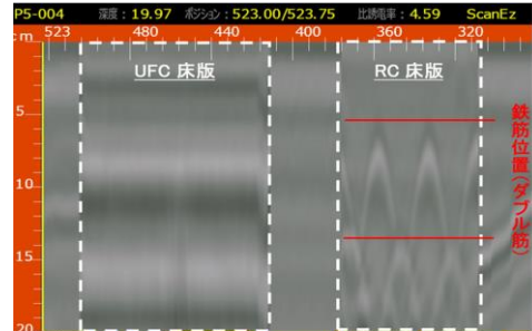
図-7 電磁波レーダ法による測定結果
