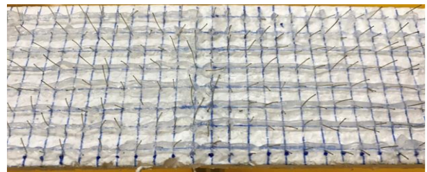
写真-2 発泡スチロールへの鋼繊維の差し込み
