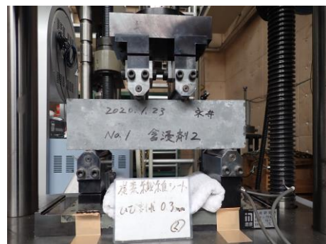
図-1 3 等分点荷重によるひび割れ導入状況
