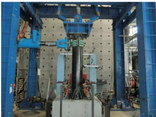
柱状付属構造物の正負交番载荷試験状況
