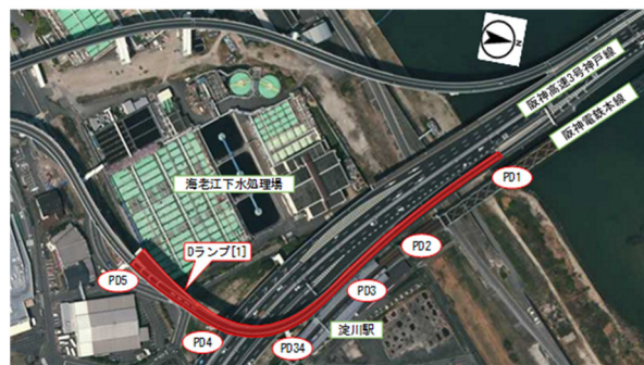
図-2 Dランプ①橋平面図
