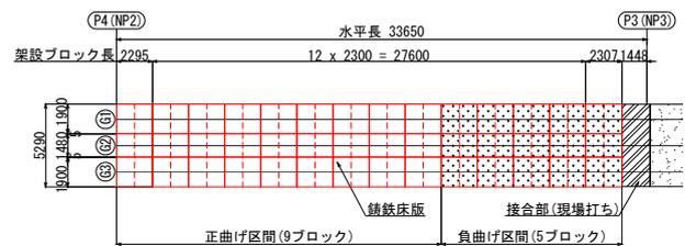
図-6 架設ブロックの割付
