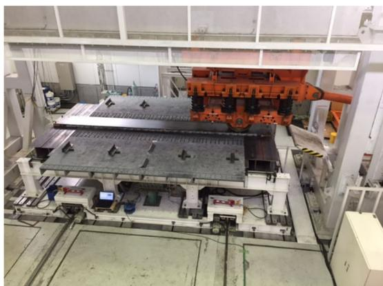
写真-1 床版部材の輪荷重走行試験
