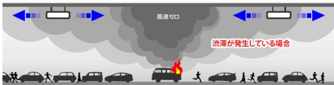
図-1 トンネル内火災時に火点前方で渋滞が発生している場合の排煙制御（低風速化制御）
