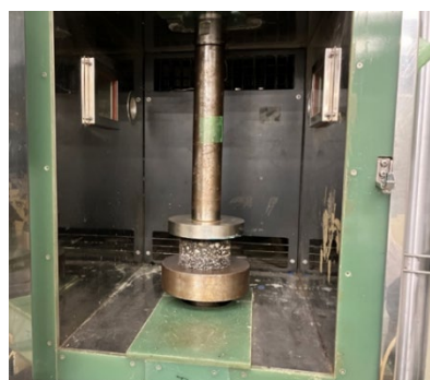
図-1 万能試験機外観および試験状況
