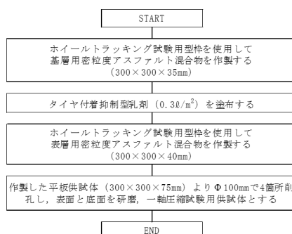
図-2 供試体の作製フロー
